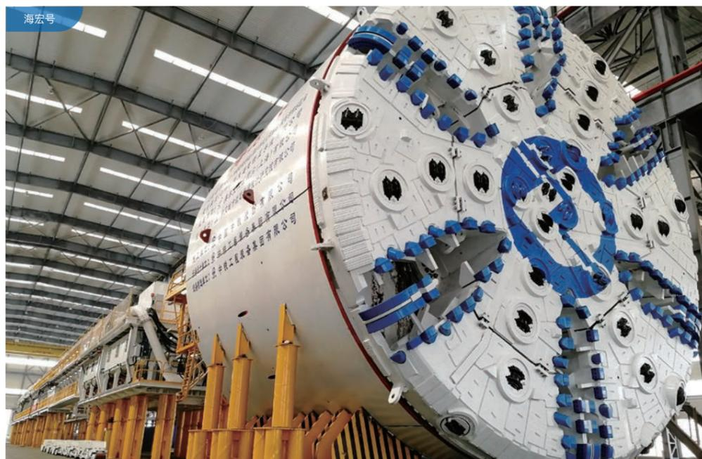
7月5日，用于大连地铁5号线的大直径泥水平衡盾构机海宏号（12.26m），被媒体誉为最聪明的盾构
