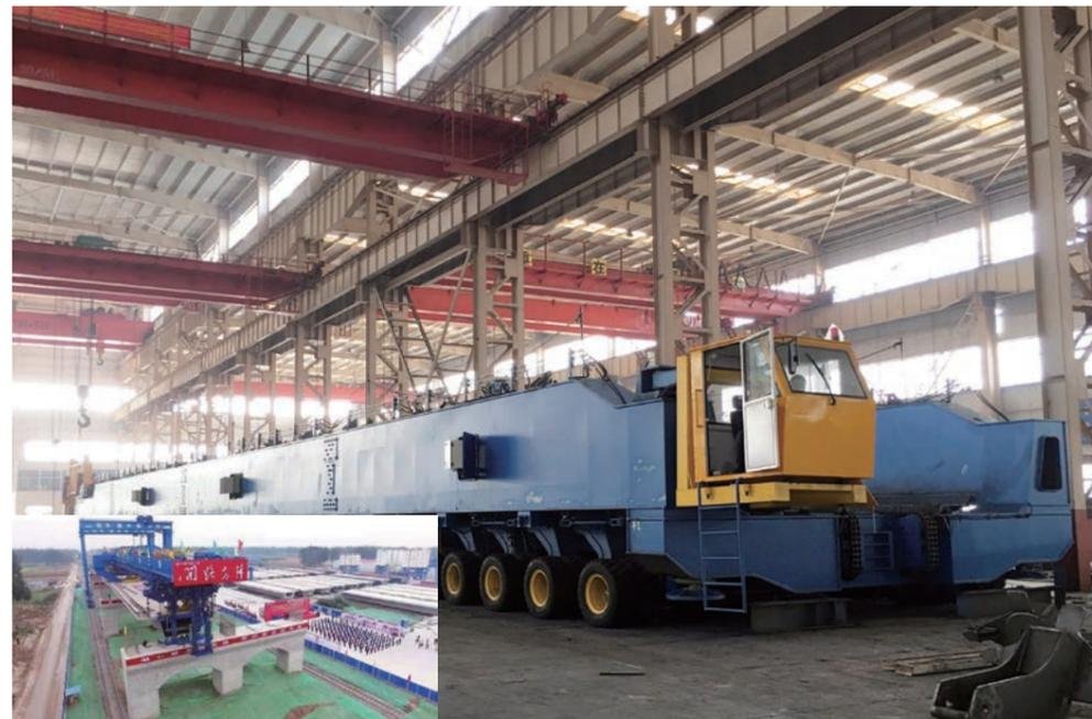
国内首台40米梁混凝土箱梁运输车顺利完成设计及安装制造，并在郑济高铁施工现场成功将一片重达1000t、跨度40米的简支箱梁落在两桥墩间
